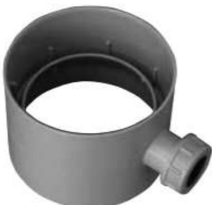
Toto okruží je vhodné montovat všude tam, kde je delší vertikální odtahové potrubí od ventilátoru (neopatřené tepelnou izolací) vedeno v místech, kde může klesat v zimních měsících teplota pod hodnotu teploty rosného bodu (např. půda, nevytápěné chodby atd.). Kondenzát se vytváří vždy vně i uvnitř daného potrubí. Vnější orosení není tak problematické. Zato uvnitř potrubí kondenzát obvykle stéká do místa, kde je
